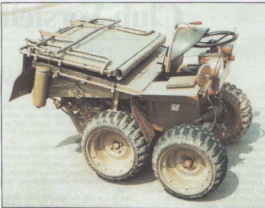
Raum dafür wäre auch in der kleinsten Hütte: Der in jeder Weise ungewöhnliche Faun Kraka läßt sich platzsparend auf 64 Prozent seiner Grundfläche zusammenklappen.
