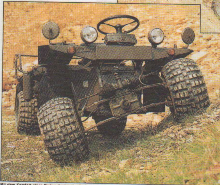
Mit dem Komfort eines Rodeopferdes: Im Gelände kommen zu den normalen Stößen von unten noch plötzliche Rollbewegungen. Die Federung ist überaus straff ausgelegt.
