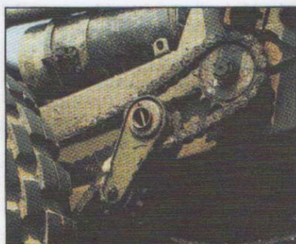
Der Faun Kraka war wahrscheinlich eines der letzten Autos mit kettengetriebenen Hinterrädern.
