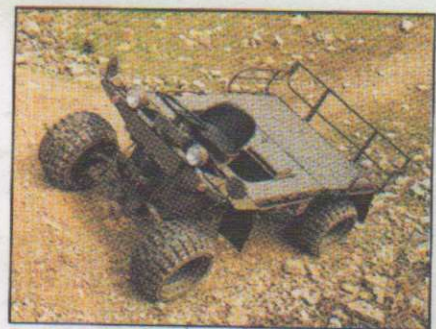
Der Fahrer sitzt zentral auf einem Muldensattel. Zwei weitere Passagiere finden Platz auf der Ladefläche.
